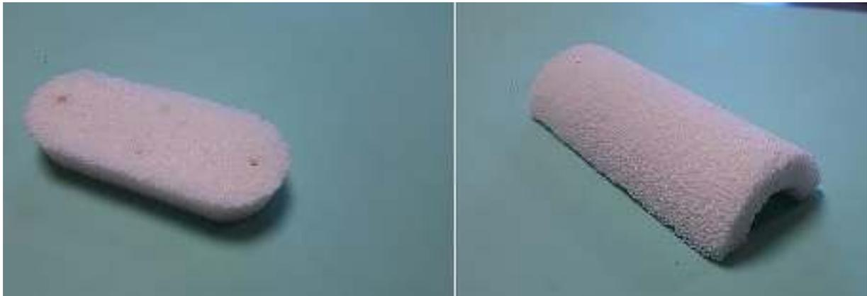
Par ailleurs, grâce à sa porosité, la pièce peut être chargée avec des molécules actives permettant de conférer de nouvelles propriétés à la céramique (cf. section 5.1.2.2)
